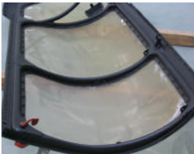
Las dos partes de la cúpula recién pintadas e imprimación del fuselaje
