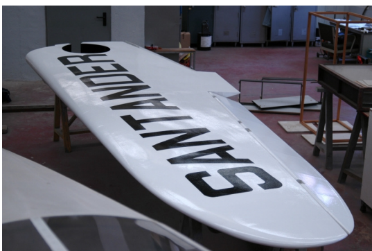
Lijado de las ala, enmascarado y pintado de los diferentes rótulos y matrículas
