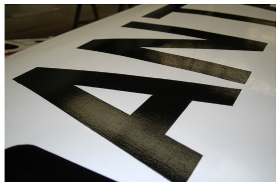
Lijado de las ala, enmascarado y pintado de los diferentes rótulos y matrículas
